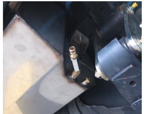
Photo 3 : Raccord de remblai/piquage par gravité
