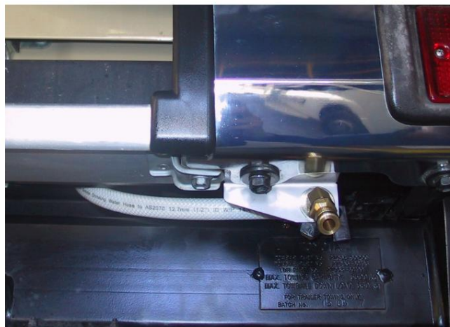
Photo 7 : Montage du robinet sur la barre arrière OEM
