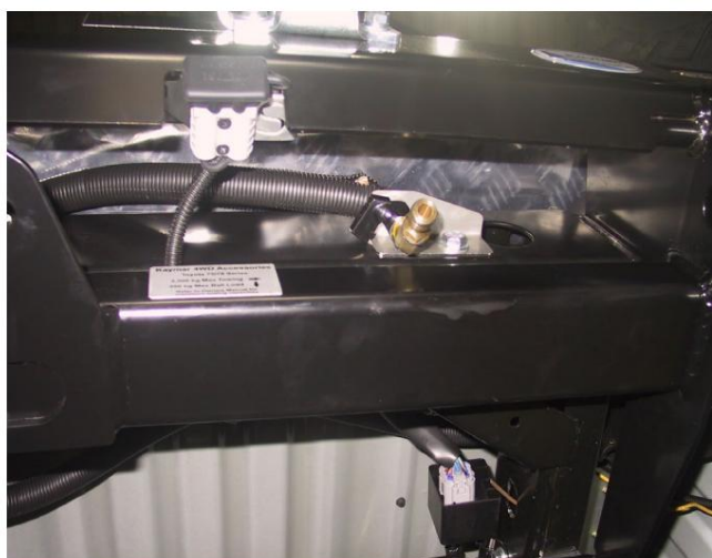
Photo 8 : Montage du robinet avec l'arrière Kaymar
