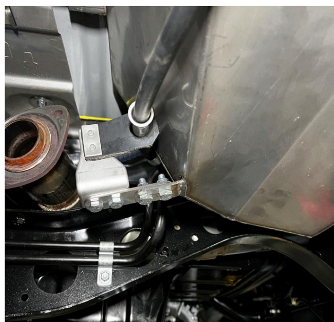
Photo 6 : Support de câble de frein à main avec 4-
