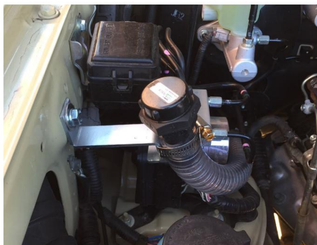
Photo 9 : Emplacement possible du remplissage sur le V8
