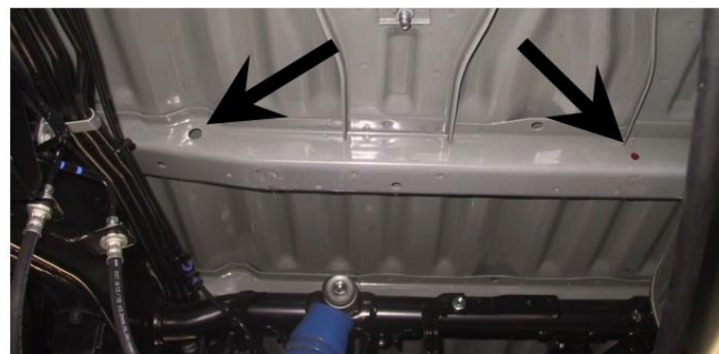
Photo 1 : Aligner le trou de montage arrière
