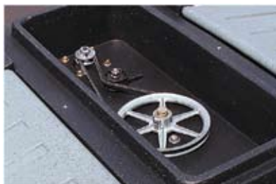
Unité d'entraînement avec braquet dans un boîtier séparé
