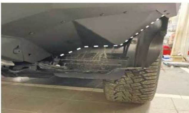
48. Pousser le volet sur la protection en plastique et marquer la ligne de coupe future. Couper le garde-boue en plastique en suivant la ligne de coupe marquée, à l'aide d'une scie à métaux ou d'un sécateur.
