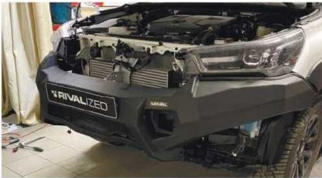
43. Installer le corps du pare-chocs (position 1) sur le support de treuil (position 3).
