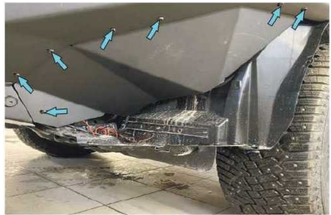
47. Installer les volets (pos.16, pos. 17), en utilisant la vis M6x20 (pos. G) et la rondelle 6 mm (pos. L).
