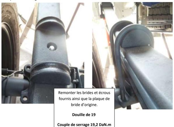
Positionner le guide sur le paquet de lames, à environ 5 cm des brides vers l'avant ou l'arrière du véhicule ; mettre l'entretoise et faire traverser le boulon dans cette dernière
