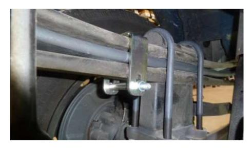
Serrer l'écrou jusqu'à ce que le guide soit maintenu et ne puisse plus coulisser
