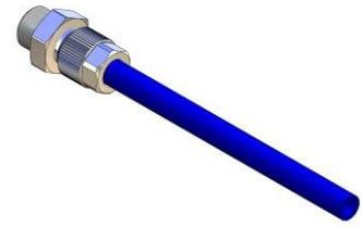
C. Fixez l'écrou par-dessus le raccord en maintenant fermement le tuyau contre le raccord, serrez l'écrou d'abord à la main et terminez le serrage avec un seul tour de clé.
