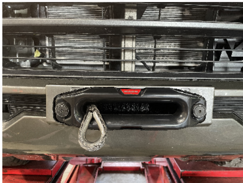
Découpe du gabarit de l'écubier sur le support de plaque d'origine Cutting the template of the hawse-tree on the original license plate holder
