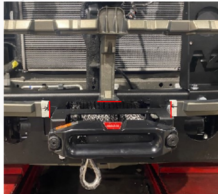
Découpe du support de calandre d'origine, pour le passage de déport d'écubier Cutting the grille support original, for the offset passage hawse
