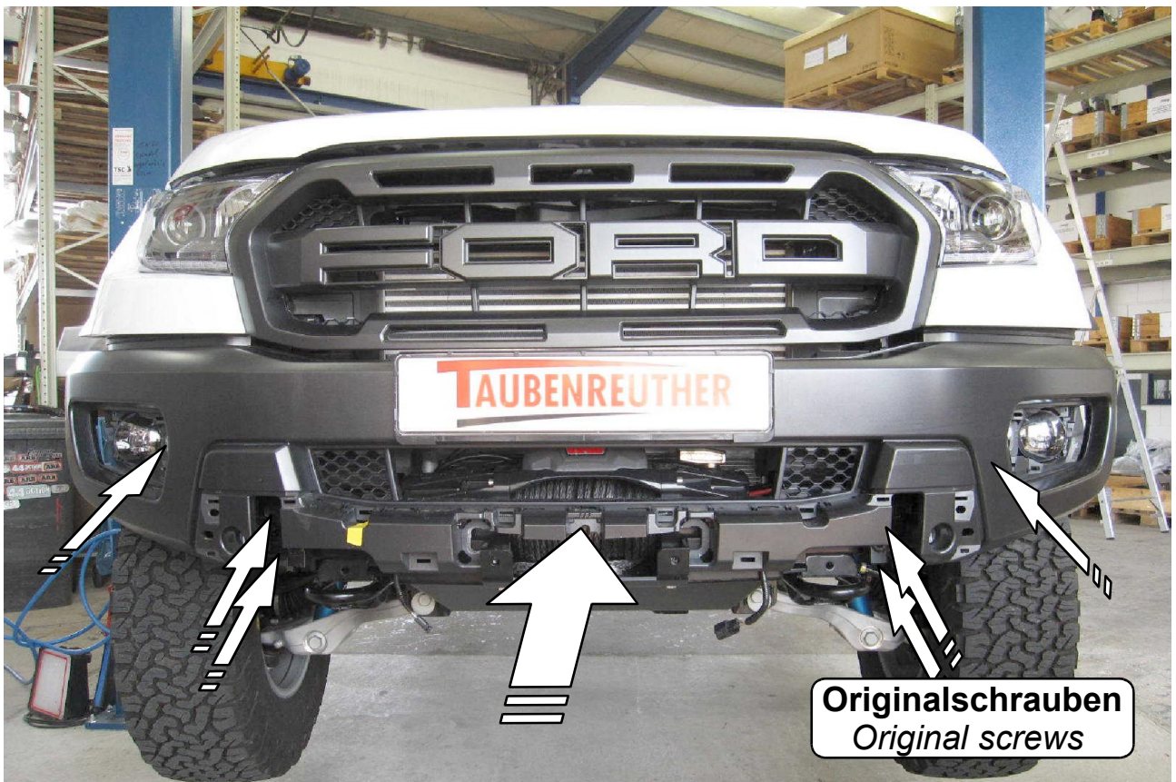
20 Stoßfänger wieder befestigen! / Mount the bumper again!
