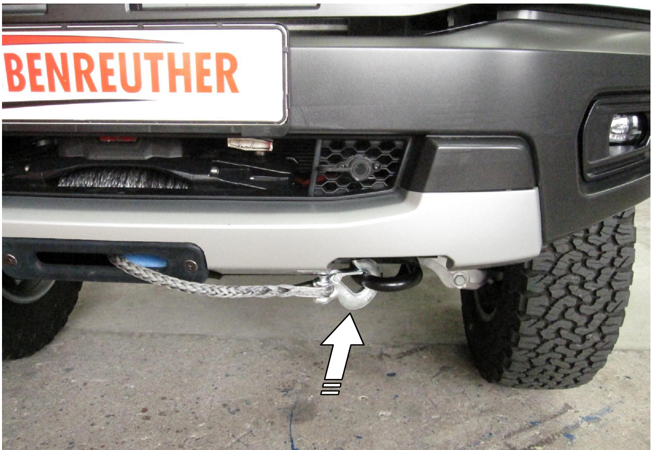
27 Bei Fahrten auf öffentlichen Straßen den Seilhaken einhängen! Hang the hook in if drive on public roads!
