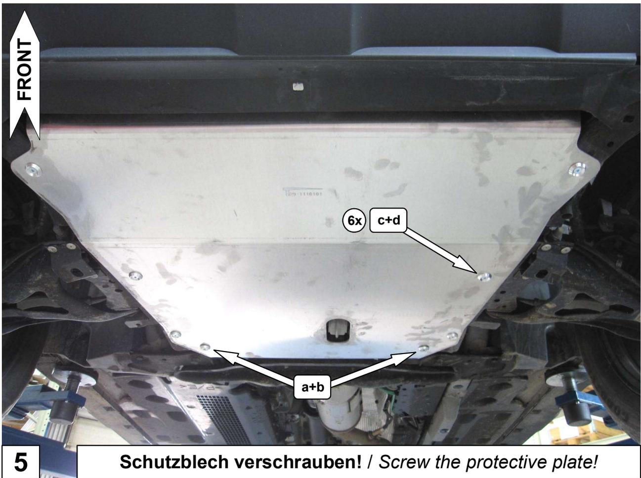
**Schutzblech verschrauben! / Screw the protective plate!**
