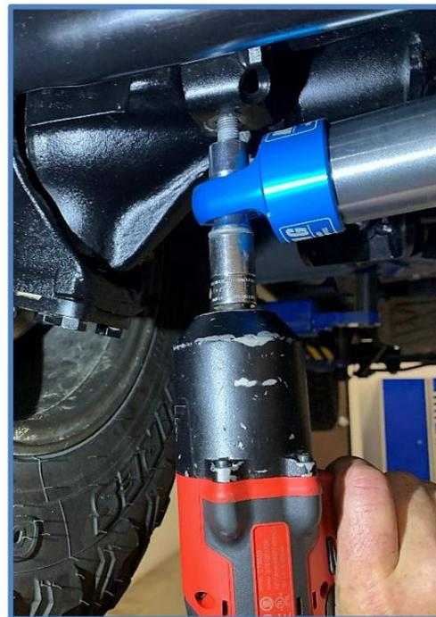
5. Placez l'extrémité de la tige dans le support de la barre d'accouplement. Installez le boulon d'usine et serrez-le selon les spécifications d'usine.
