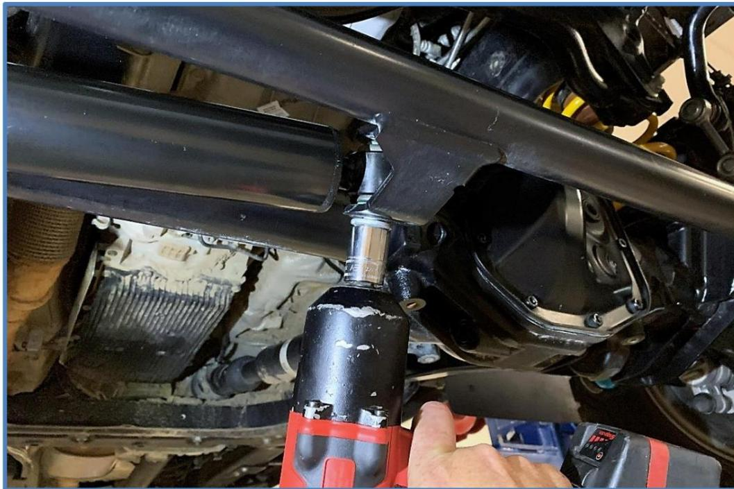
3. Installez le stabilisateur King comme indiqué. Placez l'extrémité du cylindre du stabilisateur sur le support d'essieu avec l'entretoise de roulement la plus longue face au support.
