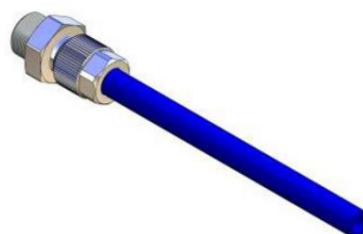
C. Insérez l'écrou jusqu'au connecteur, serrez complètement à la main et enfin serrez d'un tour supplémentaire à l'aide clés
