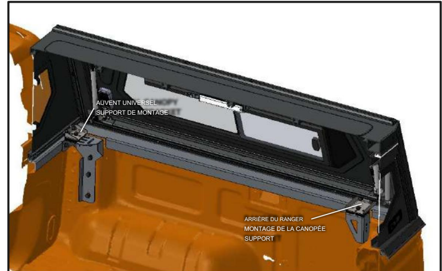
Fig 21. Position des supports de montage de l'auvent
