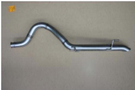
**ECHAPPEMENT INOX : TUBE ARRIERE DIAMETRE
