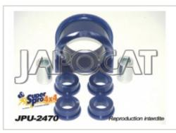
KIT SILENT-BLOCS De crémaillère de direction Polyuréthane pour Toyota HDJ100 AVANT 08/2002
