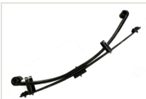
**LAME PARABOLIQUE ARRIERE TERRAIN TAMER -
