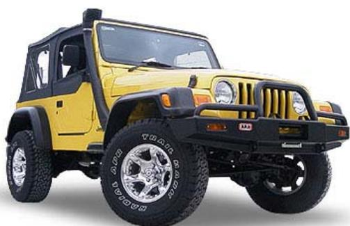
La jeep Wrangler TJ fut fabriquée de 1996 à 2005. La forme ronde de ses phares rappelle beaucoup la CJ, et la carrosserie et le châssis entièrement revus en font un véhicule tout terrain moderne d'allure classique. Les motorisations, au nombre de deux, 4 et 6 cylindres, sont d'une fiabilité éprouvée. Le 6 cylindres en ligne 4.0l développe 177 CV. Le 4 cylindres en ligne 2.5l quant à lui développe une puissance de 118 CV.
